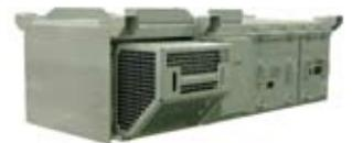
SiC半導体素子を採用した補助電源装置
