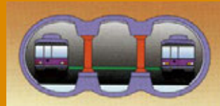
三連一体型シールド工法によるシールド駅
