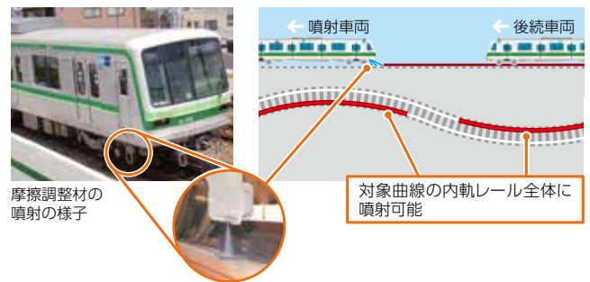
▶ 摩擦調整材の噴射イメージ図
