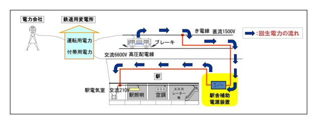
回生ブレーキで発生した回生電力(直流 1500V)を駅舎補助電源装置で交流 210V に変換し、駅の 照明や空調、エスカレーターなどに使用できるようにします。
