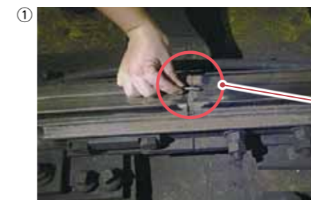
レール絶縁部に鉄片が付着(再現)
