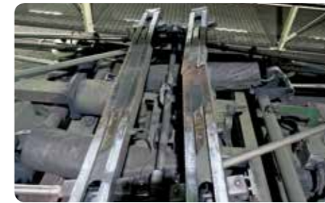
パンタグラフ損傷
