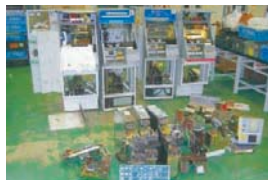
カード発売機 解体中
