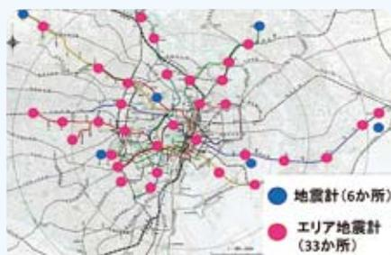
東京メトロ沿線の地震計・エリア地震計設置箇所
