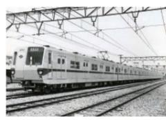
回生ブレーキ付チョップ制御装置を搭載した千代田線6000系
