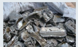
シュレッダーで破碎、選別されたアルミ素材
