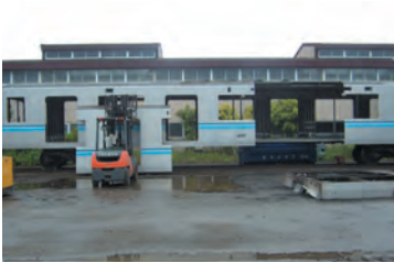
車体の分解リサイクルの様子
