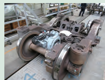
試験搭載した同期リラクタンスモーター
