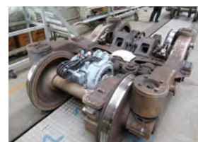
試験搭載した同期リラクタンスモーター
