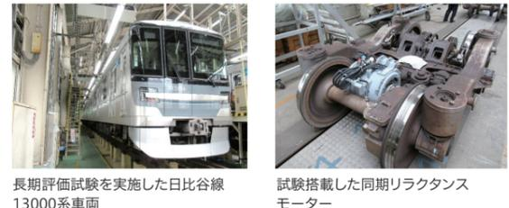
※同期リラクタンスモーター：回転子鉄心内の磁気抵抗差によって生じる磁極との相互作用で発生する「リラクタンストルク」で駆動します。鉄道車両に広く採用されている誘導モーターと比較して、回転子の発熱損失が小さく、効率や質量特性に優れることが特徴です。
