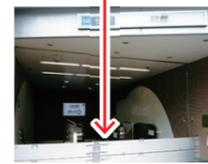
アルミ製のパネルを2～3段設置することで、水の流入を防止する。
