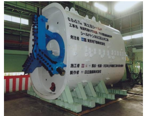
今回使用しているシールドマシン
