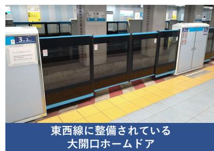
東京メトロは全9路線中7路線で相互直通運転を行っています。この7路線では車両のドア位置及びドア幅が異なる列車が運行されているため、車両の規格の統一または規格が異なる車両へ対応できる大開口ホームドアを採用し、ホームドアの全駅設置に向けて取り組んでいます。
