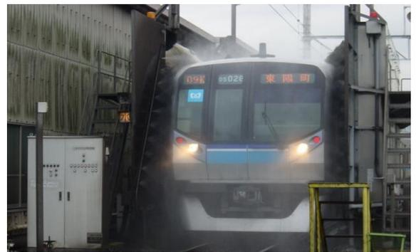
▲リサイクルした洗浄水を使用して車体洗浄を行う様子
