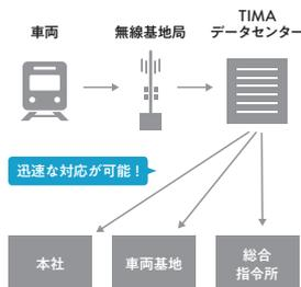
「TIMAシステム（車両情報監視・分析システム）」を導入。走行中の車両の状態を総合指令所や車両のメンテナンスを行う部署から遠隔でモニタリングを行います。
