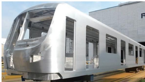
ボディにアルミニウム合金を用いることで、車体強度を確保しながら軽量化を実現しています。また、アルミニウム合金の種類を極力統一することでリサイクル性を高めています。
