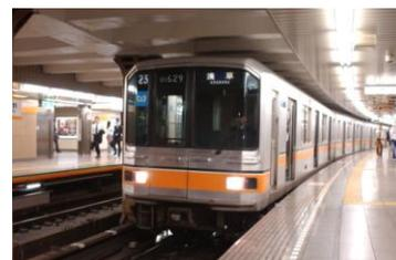
銀座線新型車両1000系は、環境負荷低減として永久磁石同期モータやLED照明、また走行騒音低減として操舵台車を採用するなど、数々の最新技術を取り入れた車両です。
