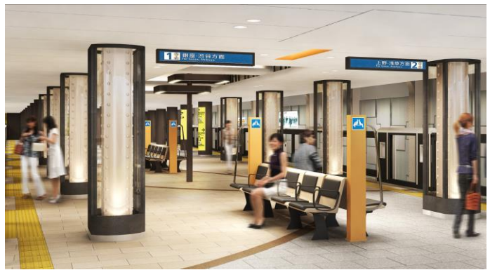
柱（鉄鋼框）をガラスで仕上げたプラットホーム
