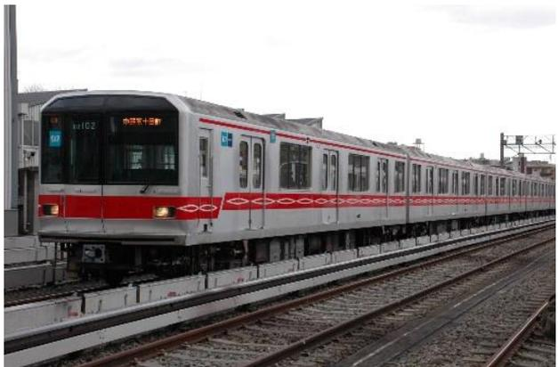
1988年から製造された車両で、300形の面影を残したデザインをアルミ無塗装車体で表現するために、先頭形状と識別帯でその特徴を表現しました。先頭部は300形のイメージを残すため上部に丸みをつけました。
