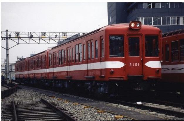
1959年から製造され銀座線で活躍していましたが、1968年から丸ノ内線分岐線用の車両として転籍しました。銀座線と丸ノ内線では車体幅が異なるため、乗降口下部にステップを取り付けて、車体幅不足を補いました。
