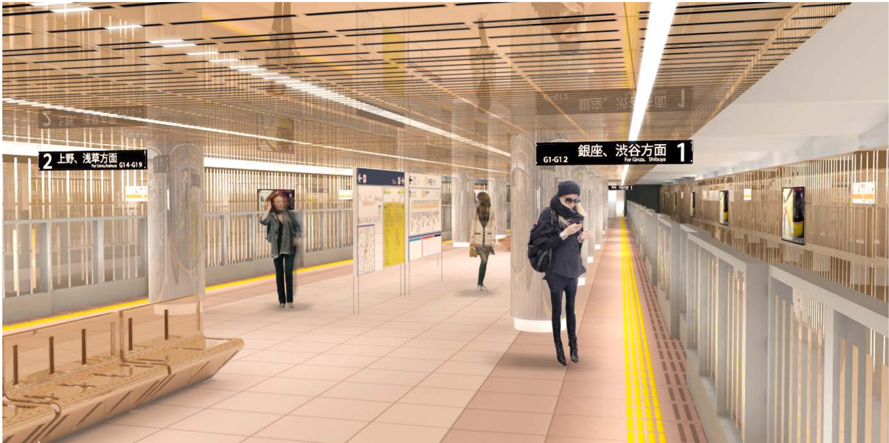
神田駅プラットホーム：天井と壁に大きさの漸変する縦格子の有孔鉄板。床は4段階の同色系列のタイル。柱はステンレスミラーシートを巻き上下に照明を設置している。ホームドアには縦格子のプリントが印刷される。
