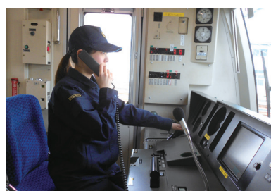
非常通話装置通話機能の点検
