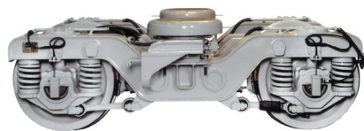
PQモニタリング台車 (丸ノ内線、東西線、千代田線、有楽町線、副都心線、半蔵門線導入済、今後他路線に導入検討)
