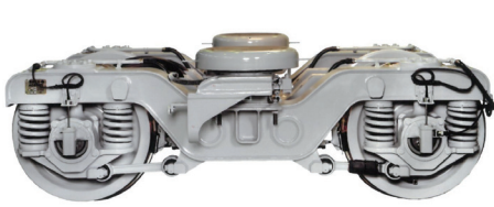
PQモニタリング台車 (丸ノ内線、東西線、千代田線、有楽町線、半蔵門線、副都心線導入済、今後他路線に導入検討)
