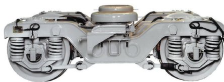
PQモニタリング台車 (丸ノ内線、東西線、千代田線、有楽町線、半蔵門線、副都心線導入済、今後他路線に導入検討)
